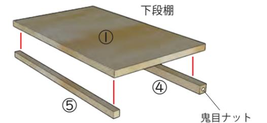
\*下段棚は④が左右20mm均等に飛び出るよう計測して接着
