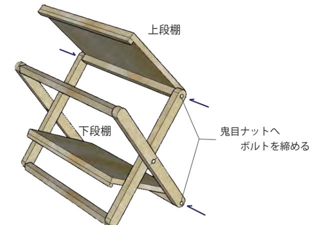
① で作った板と② で作った脚を矢印部でボルトで軽く締める
